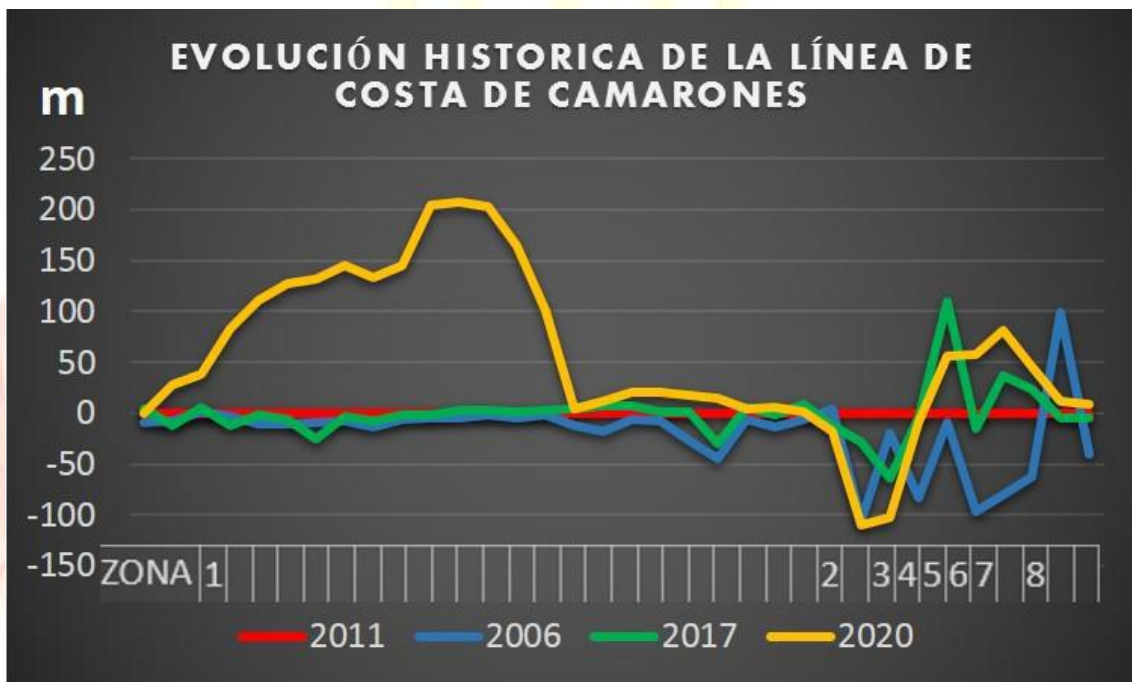
FIGURA # 7. EVOLUCIÓN HISTÓRICA DE LA LÍNEA DE COSTA A PARTIR DEL AÑO 2006 AL 2020, TOMANDO COMO REFERENCIA LA LÍNEA DE COSTA OFICIAL DEL INOCAR (2011). FUENTE PROPIA.
